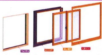
既存窓の枠だけを残して新しい窓を取付
